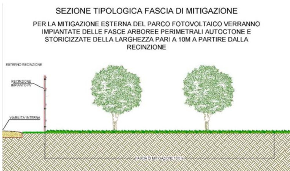
Figura 7 – Sezione tipologica fascia di mitigazione perimetrale
