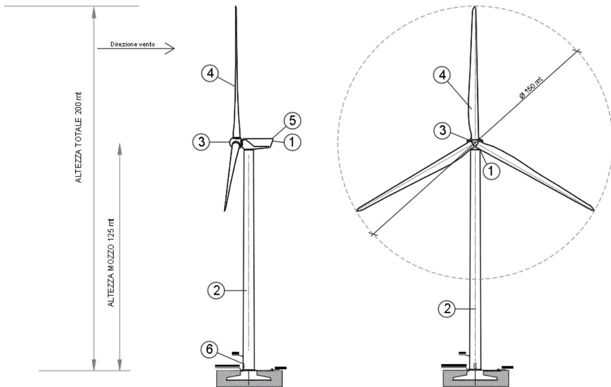
Figura 2 – Tipico dell'aerogeneratore in progetto, con dimensioni di ingombro (2022030\_ElaboratoGrafico\_9.13)
