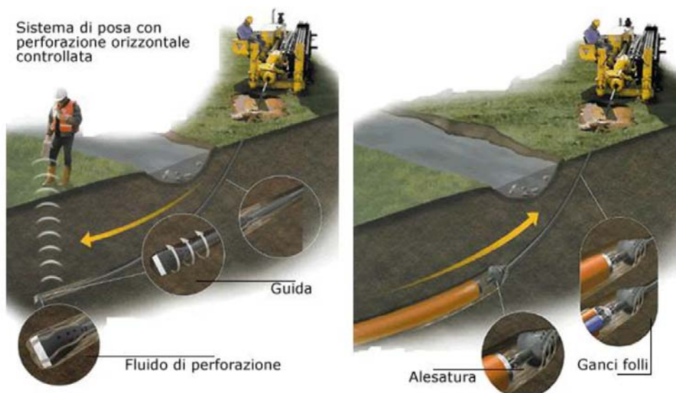
Figura 54 - Posa in opera tubazione per alloggio cavi
