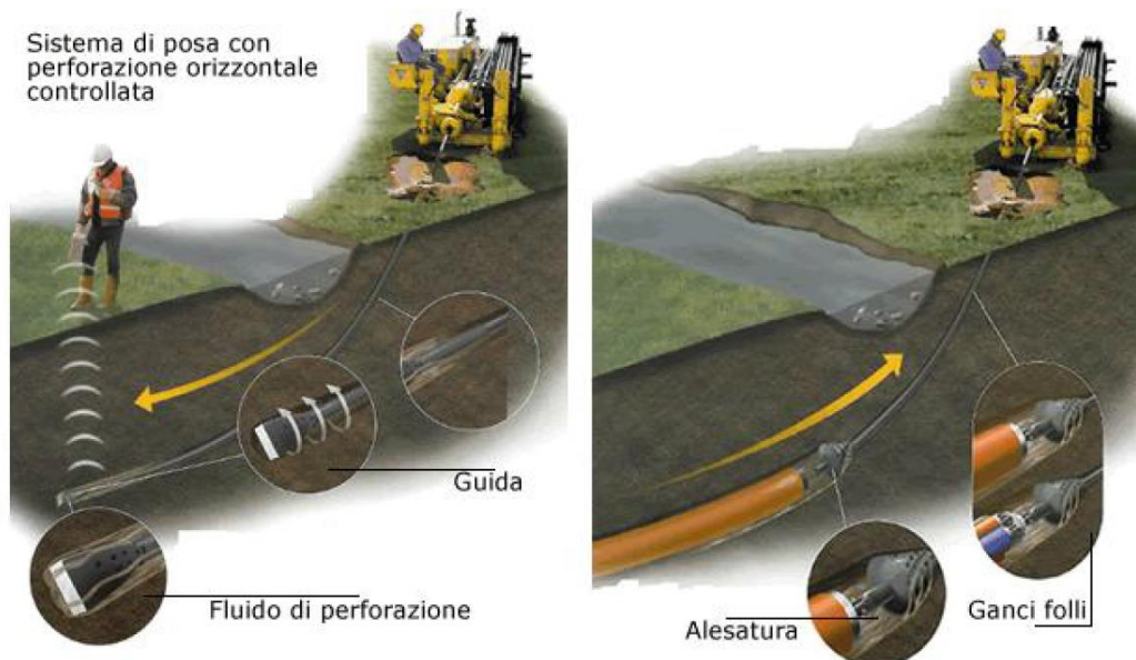
Figura 28 - Posa in opera tubazione per alloggiamento cavi
