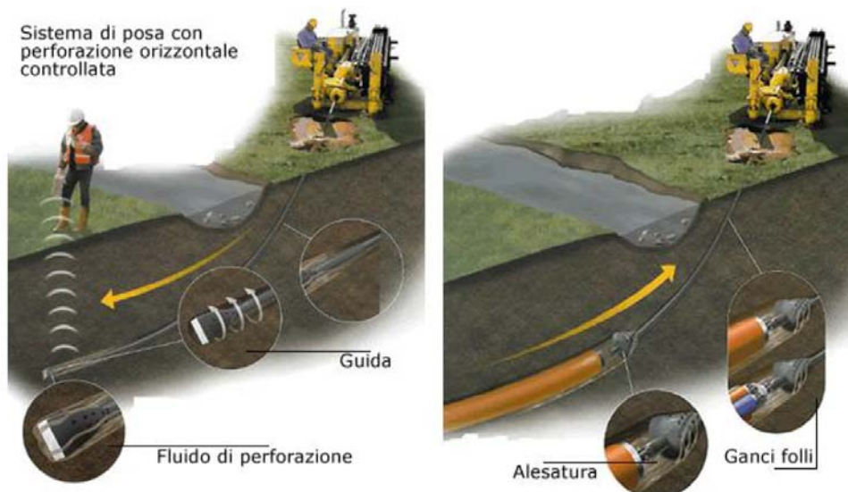
Figura 20 - Posa in opera tubazione per alloggio cavi
