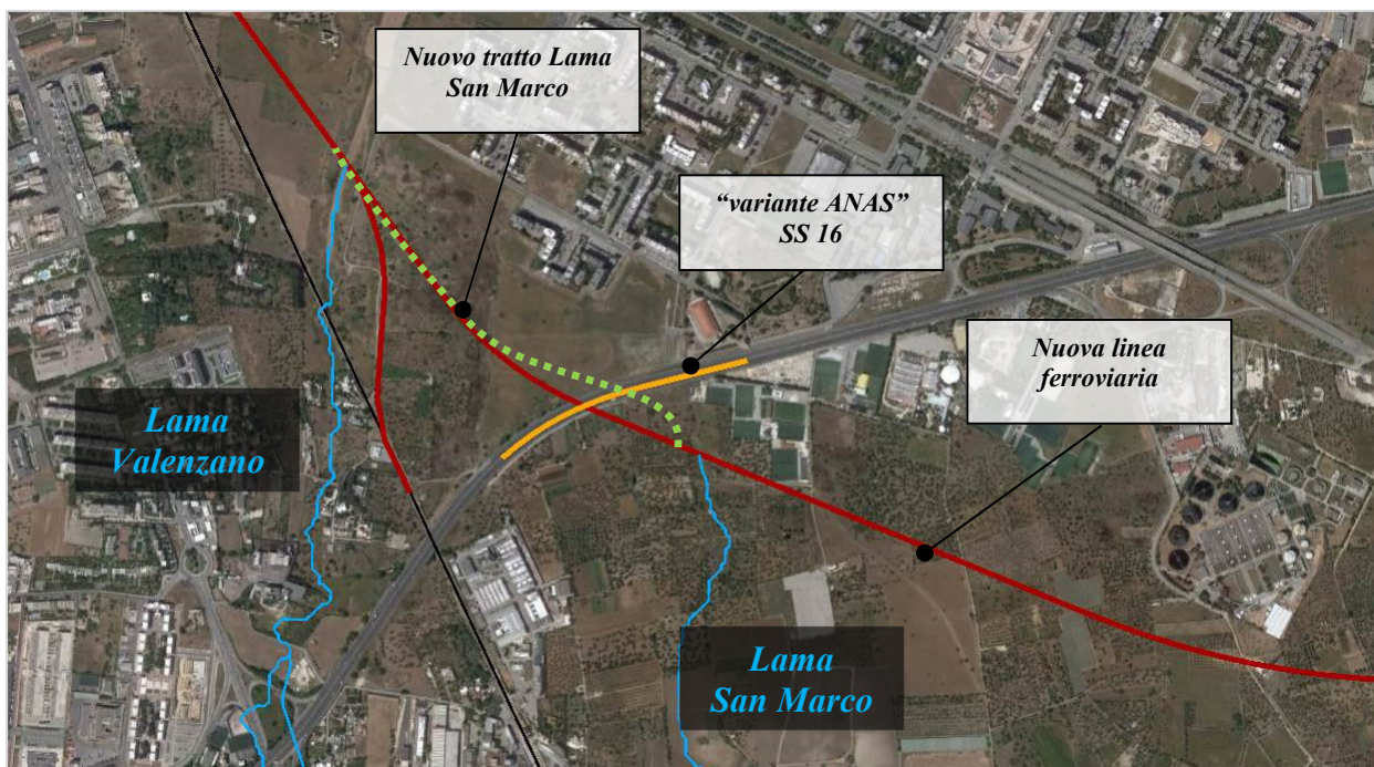
Planimetria dell'attraversamento ferroviario e stradale della Lama Valenzano e della Lama San Marco
