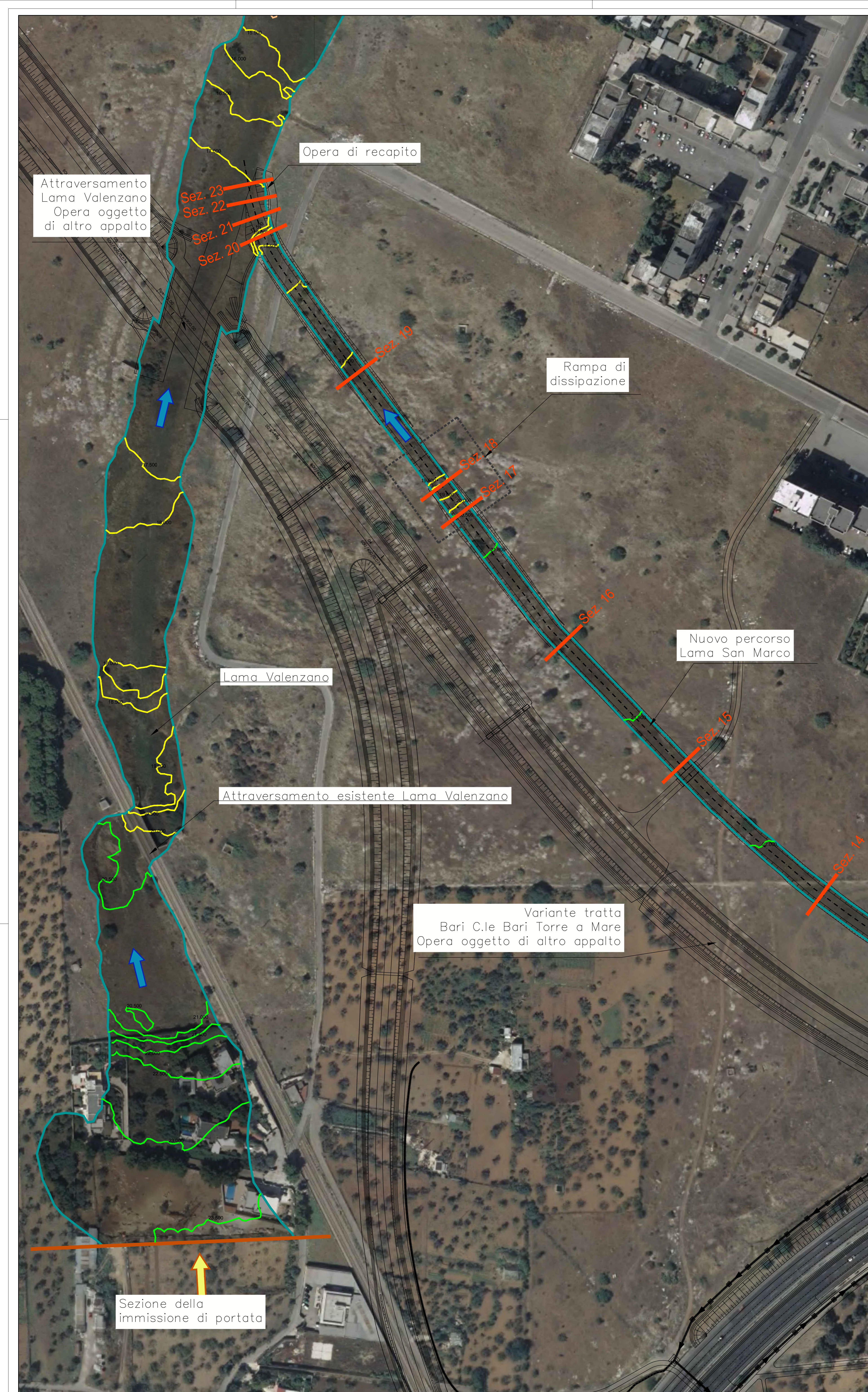
POST OPERAM - Riquadro N°1 - Planimetria aree allagate, massimi livelli idrici, TR 200 anni - scala 1:1000
