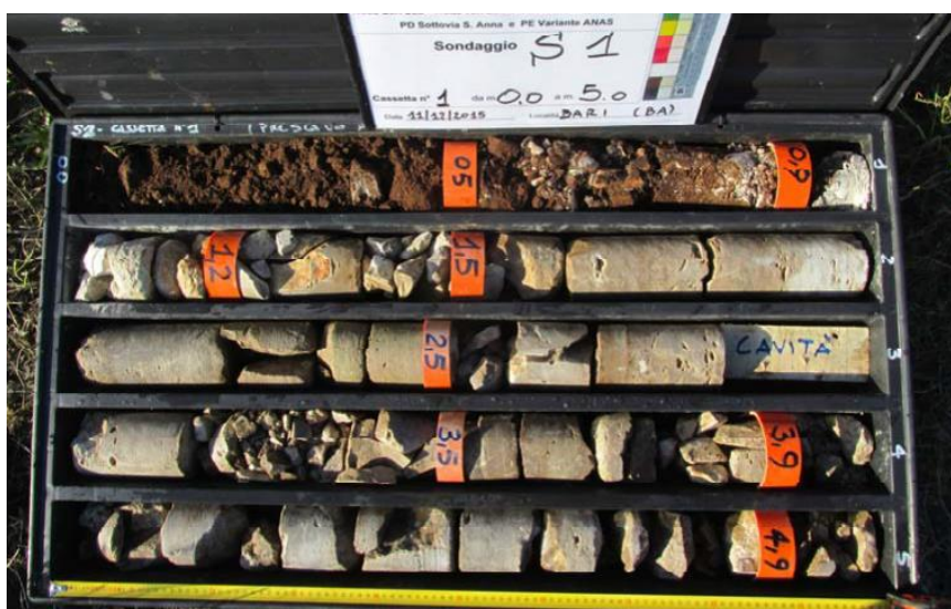
Figura 7 –sondaggio S1 (da 0.0 a 5.0 m da p.c.)
