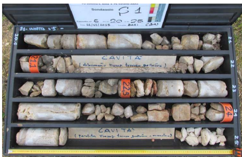
Figura 8 –sondaggio S1 (da 20.0 a 25.0 m da p.c.)
