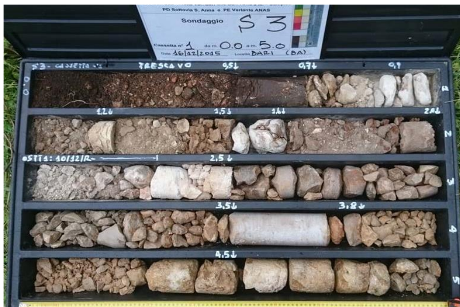
Figura 9 –sondaggio S3 (da 0.0 a 5.0 m da p.c.)
