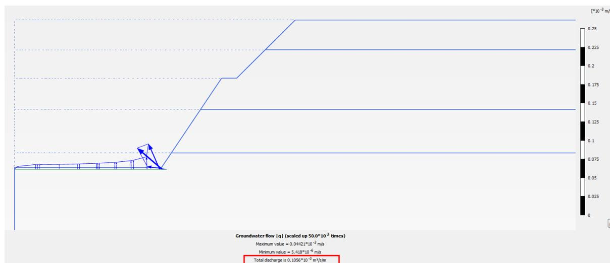
Figura 8 – Fase di scavo finale (linee di flusso e valore di portata di calcolo) –  $q = 0.11 \cdot E^{-03} \text{ m}^3/\text{s}$
