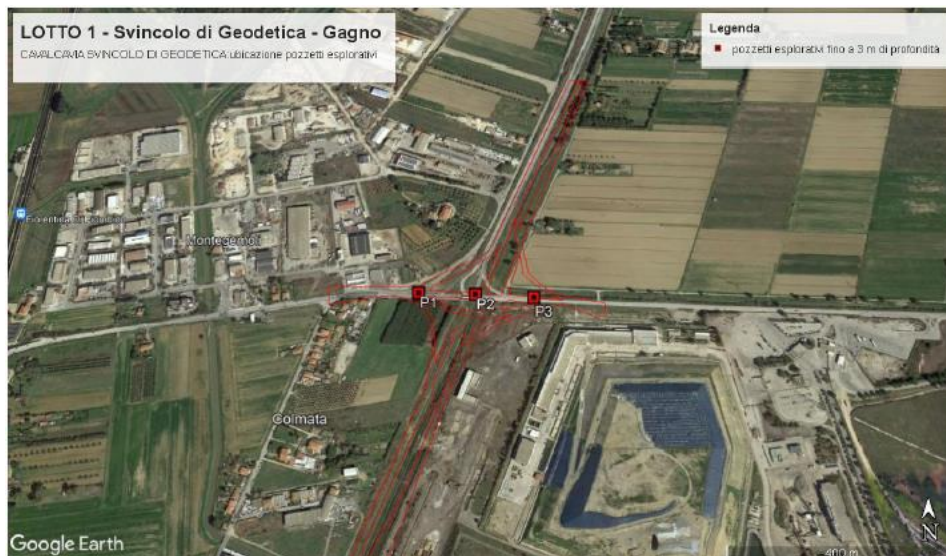
Figura 4 Ubicazione dei pozzetti esplorativi realizzati per la caratterizzazione dei materiali prodotti dalla realizzazione delle spalle e delle pile del cavalcavia svincolo di Geodetica
