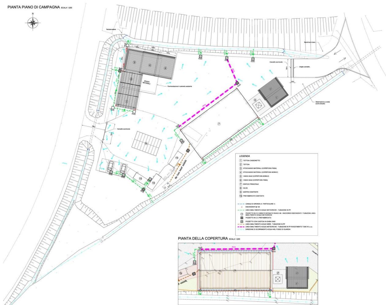
Planimetria della sistemazione idraulica del piazzale
