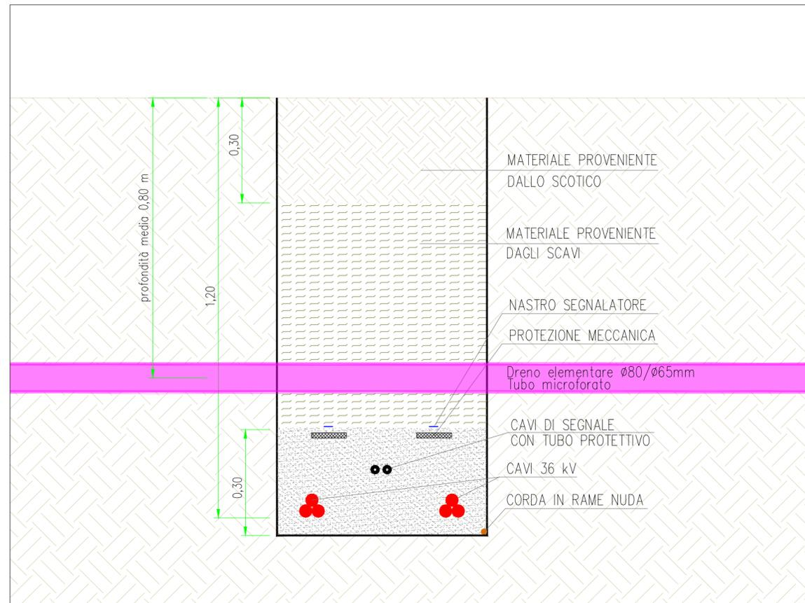
Tipico posa tubazioni sistema di drenaggio interferenza con cavi DC - Scala 1:10
