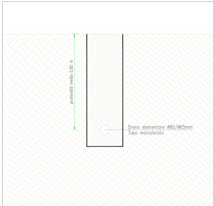
Tipico posa tubazioni sistema di drenaggio interferenza con cavi 36 kV - Scala 1:10
