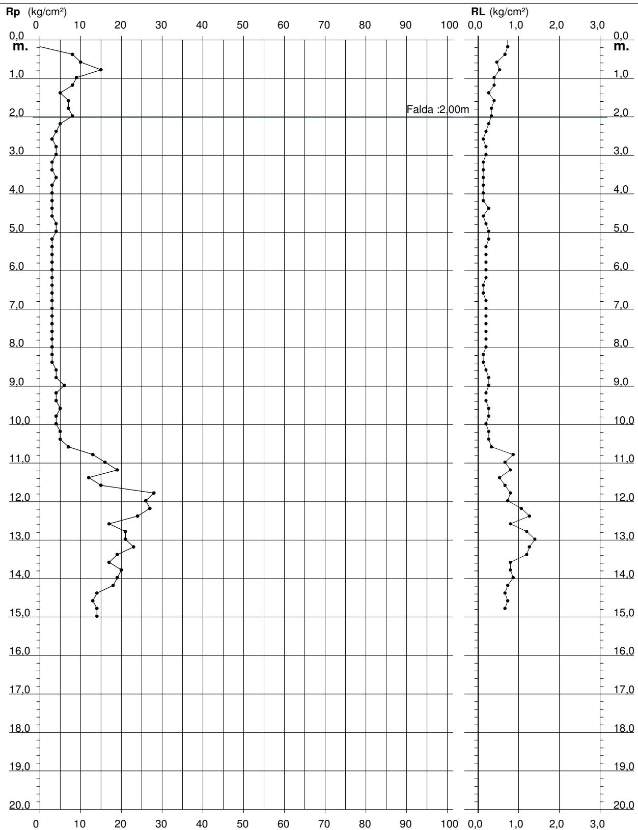
**PROVA PENETROMETRICA STATICÀ
