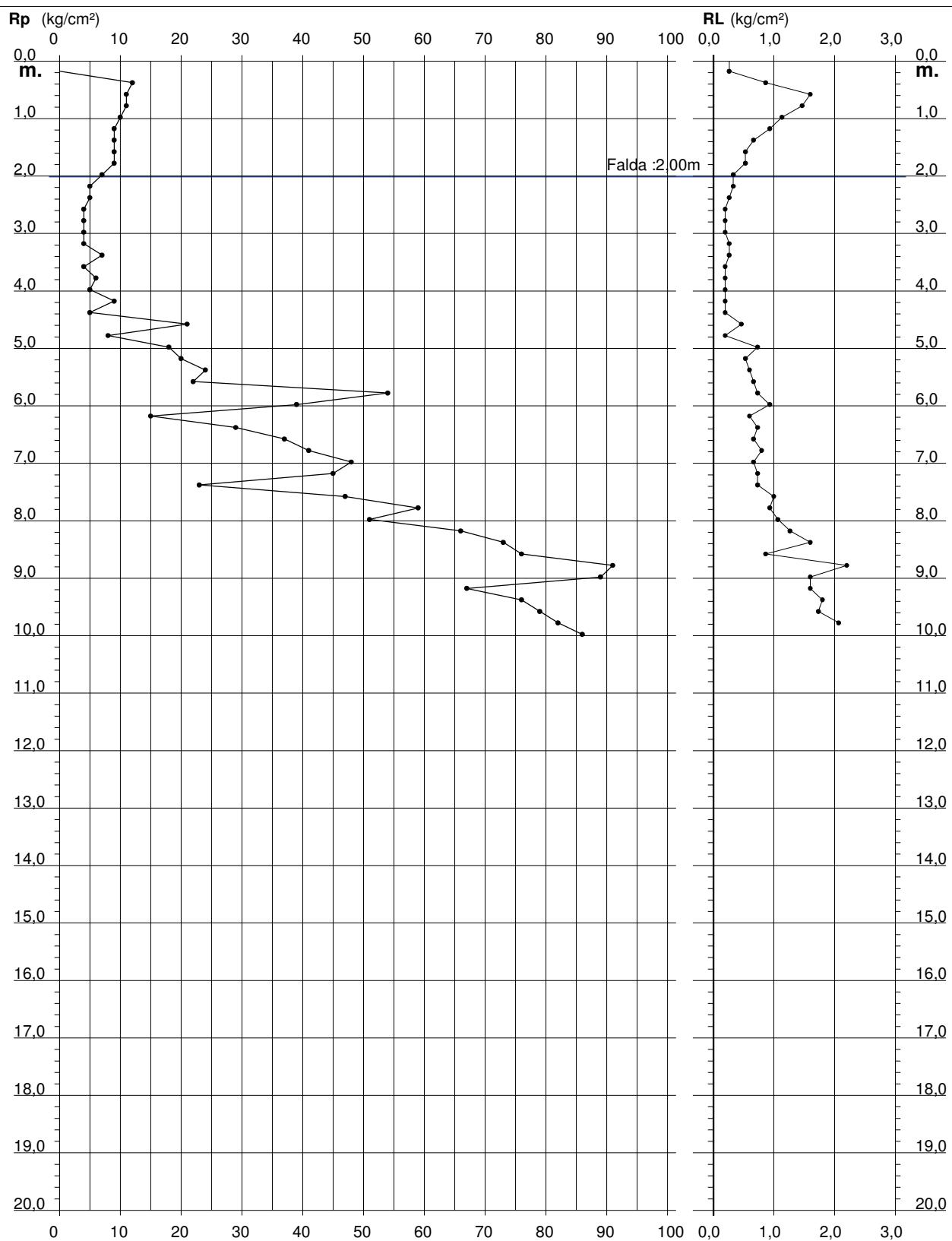
**PROVA PENETROMETRICA STATICÀ
