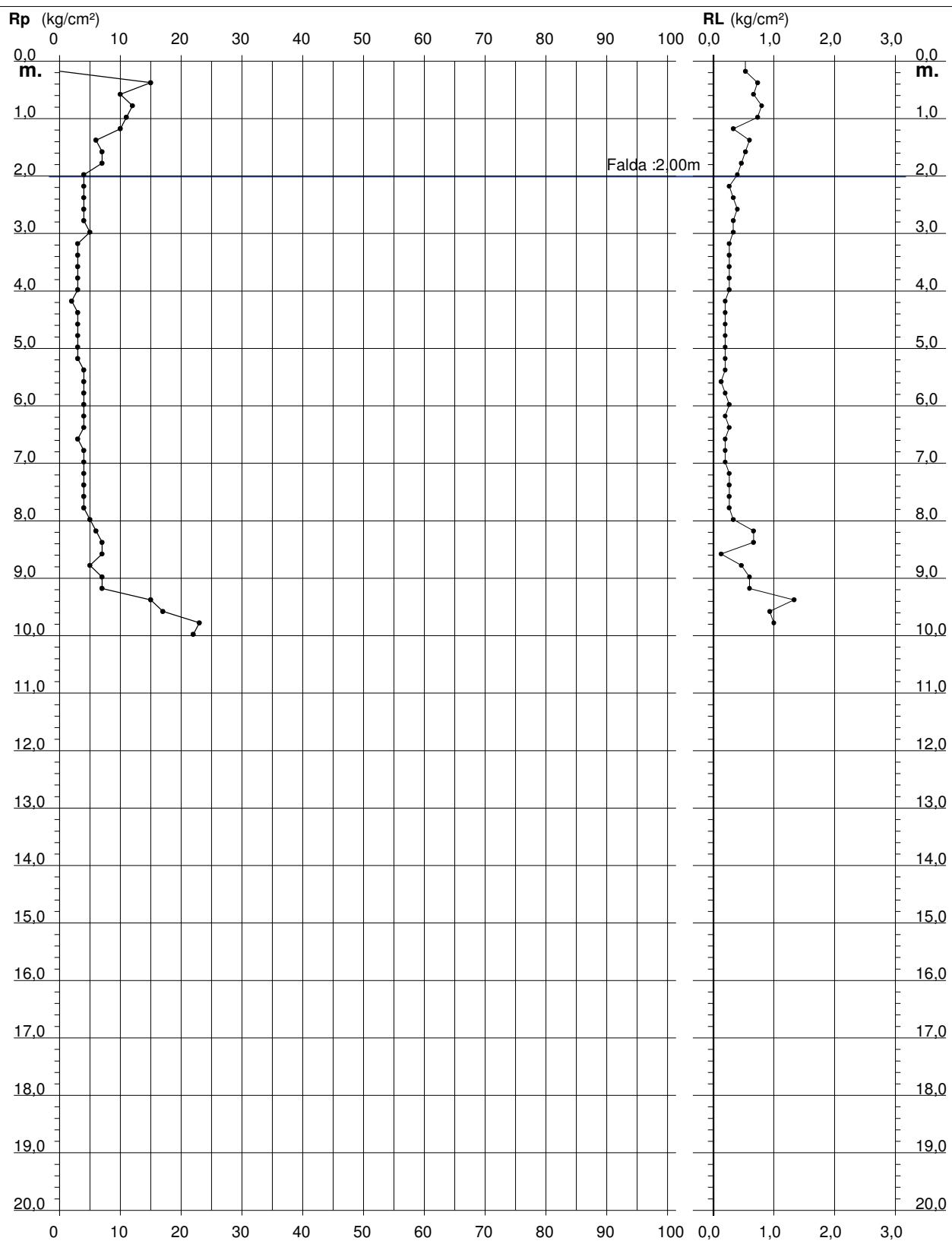
**PROVA PENETROMETRICA STATICÀ
