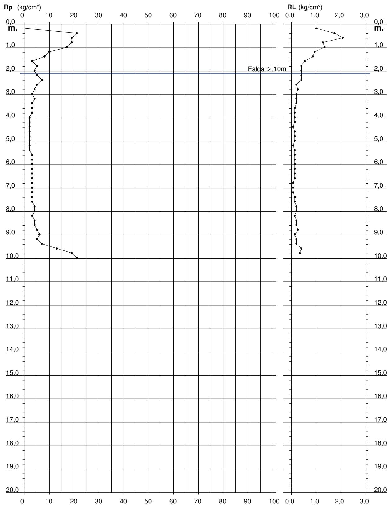
**PROVA PENETROMETRICA STATICÀ
