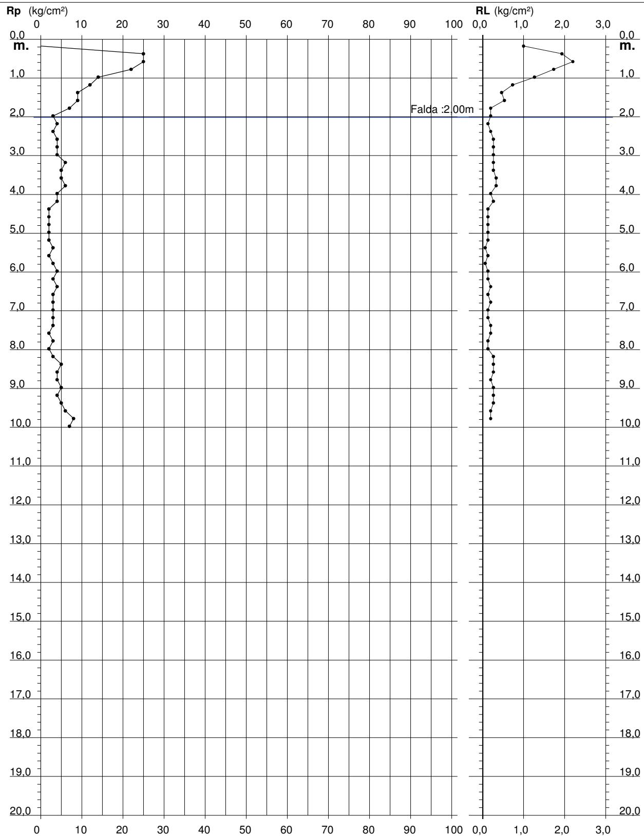
**PROVA PENETROMETRICA STATICÀ
