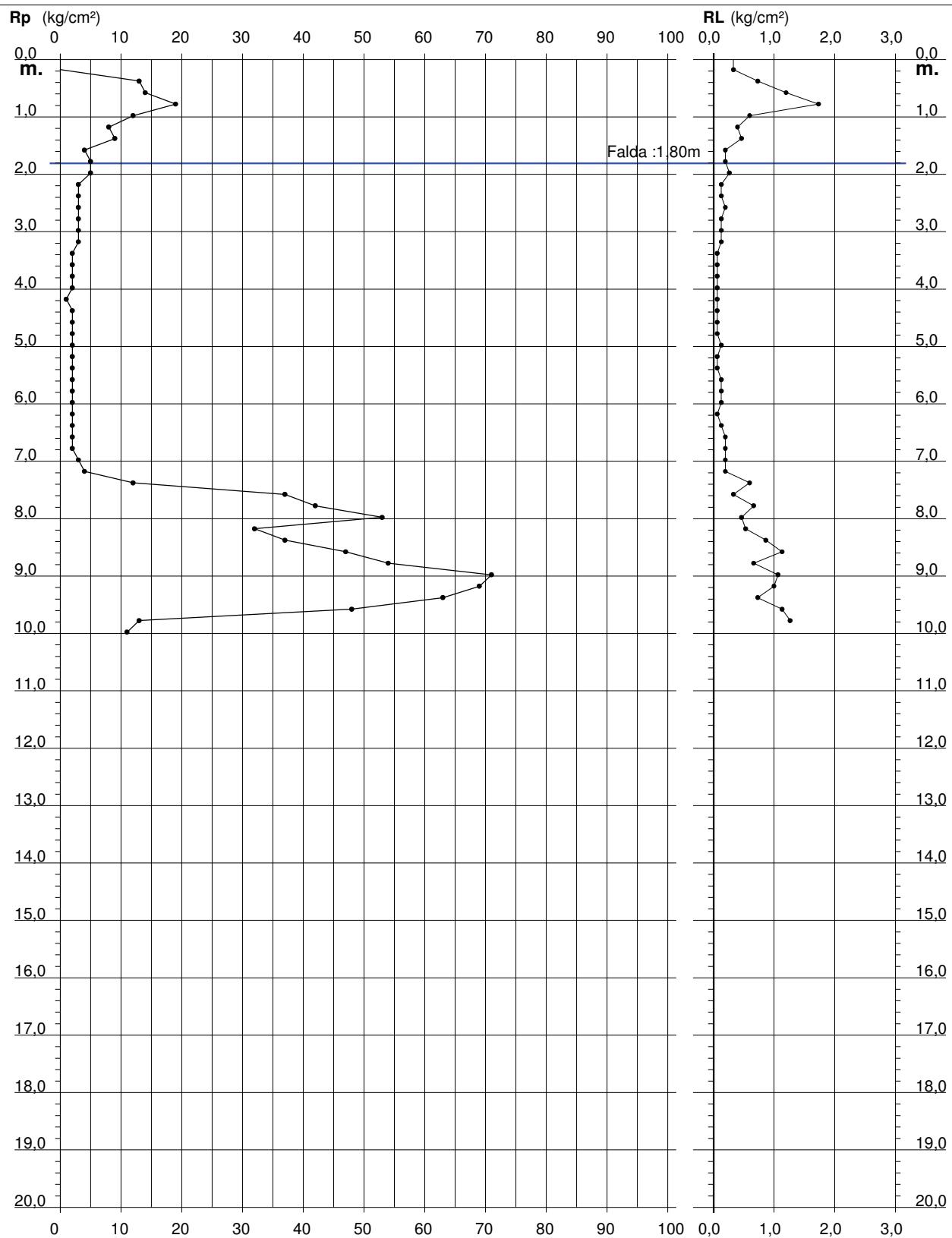
**PROVA PENETROMETRICA STATICÀ
