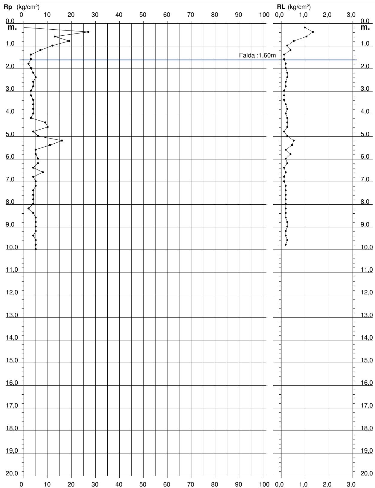
**PROVA PENETROMETRICA STATICÀ
