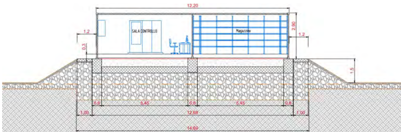
Figura 64: Sezione di progetto - fondazione control room
