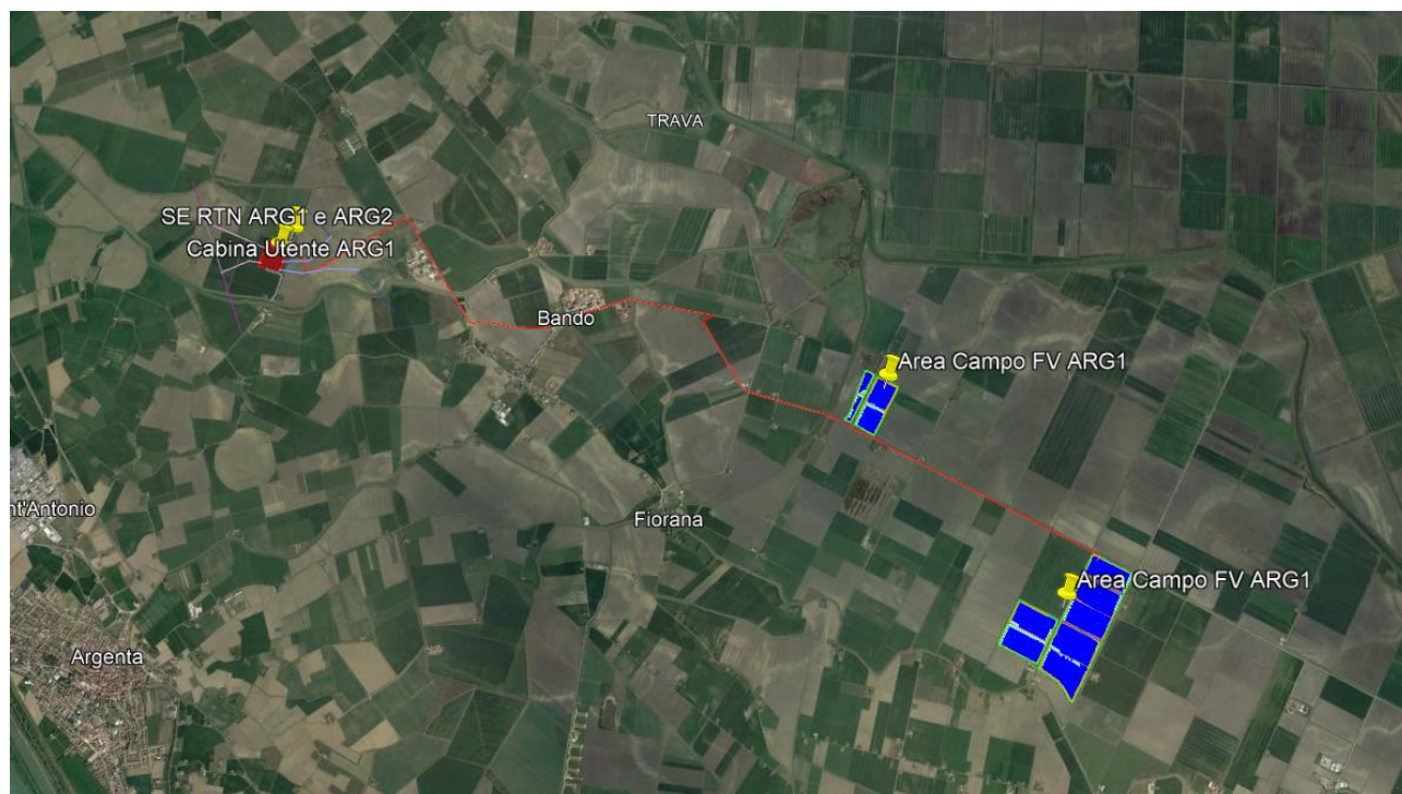
Figura 3-1: Inquadramento delle aree di progetto, con indicate in colore blu le aree in cui verrà installato il campo agrivoltaico di progetto mentre in colore rosso l'area in cui verrà installata la Cabina Utente. Sono inoltre indicati con una linea di colore rosso le dorsali a 36 kV di progetto.
