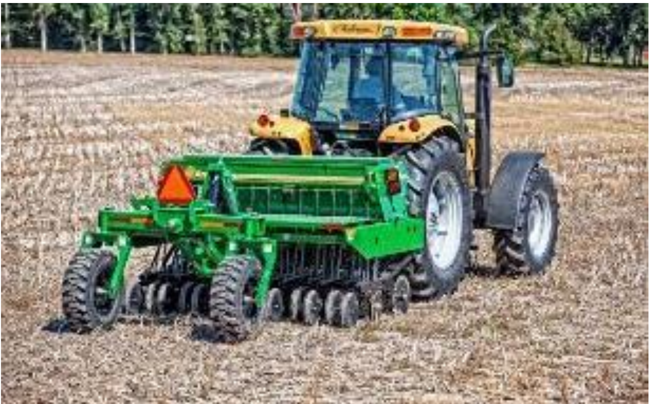
Figura 5.15 - seminatrice da sodo
