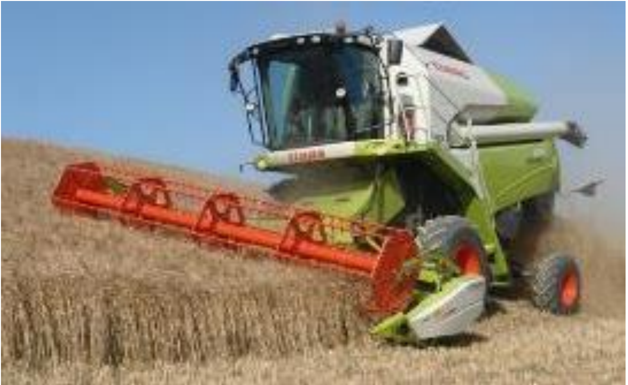
Figura 5.16 - macchina raccoglitrice per la raccolta di cereali autunno vernini
