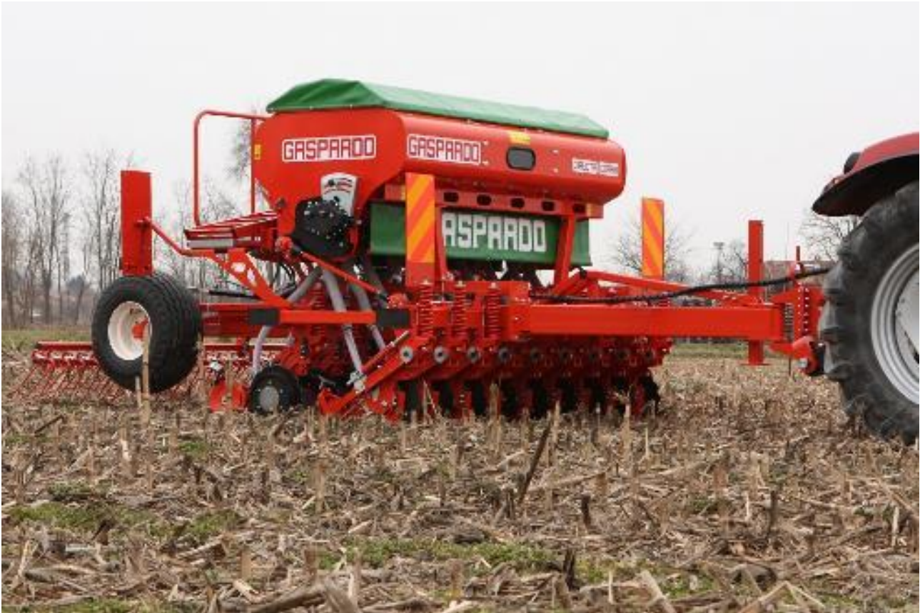
Figura 3.17 - macchina combinata erpice rotante – rullo frastagliato: visione anteriore e posteriore
