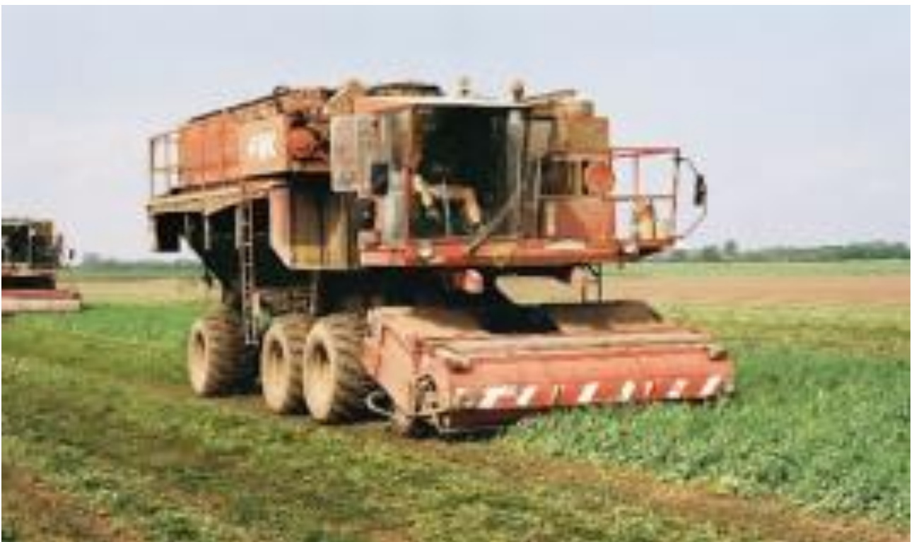
Figura 5.17 - macchina raccoglitrice per il pisello proteico
