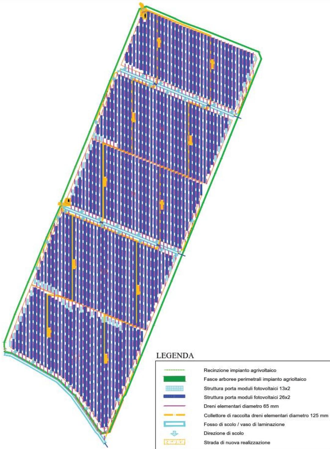
Figura 4-3 Layout impianto agrivoltaico e sistema di drenaggi Area 3
