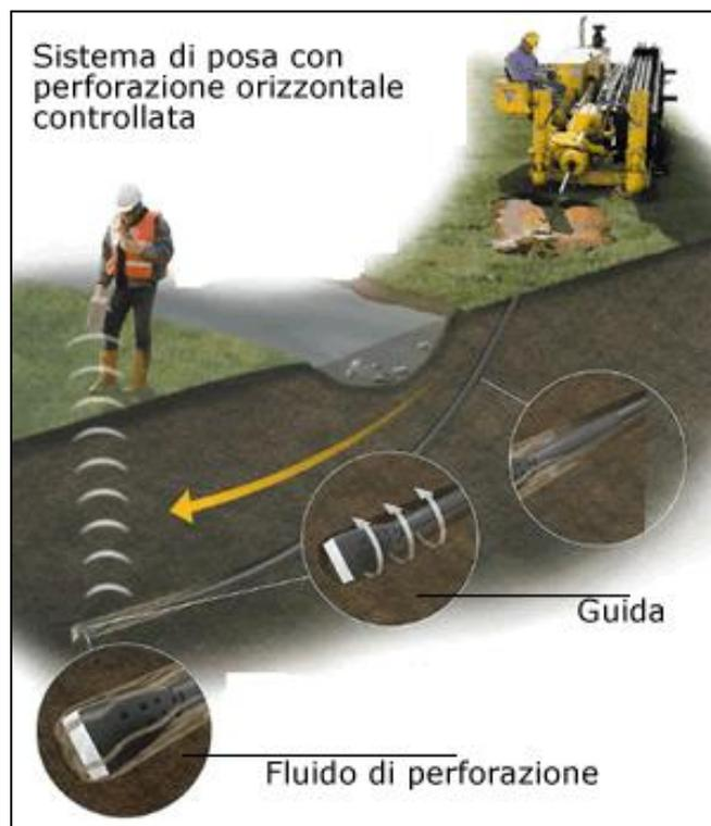
**Figura 4-1 - Macchina perforatrice (fonte web)**
