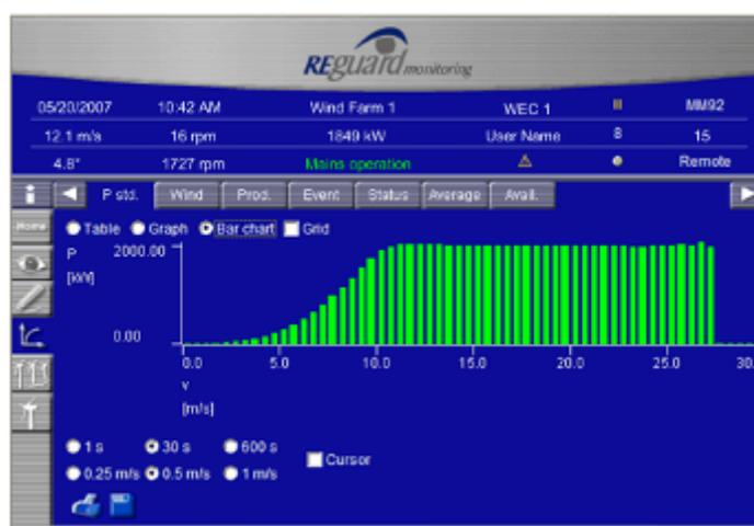
SCADA – Visualizzazione Curva di Potenza – Velocità.
