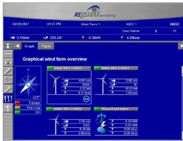
SCADA – Visualizzazione Stato del Parco Eolico.
