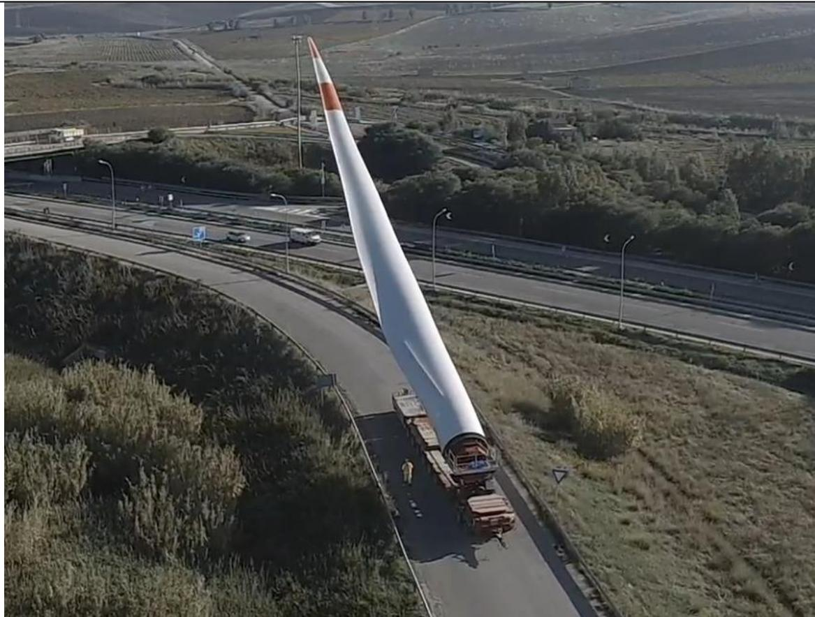
Figura 49 - Immagine 2 - Blade lifter in azione
