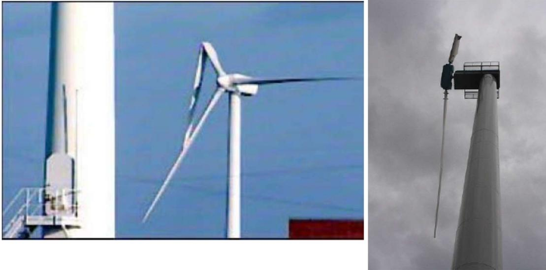
*Fig. 7 Esempio di rottura di pala senza distacco e con distacco*
