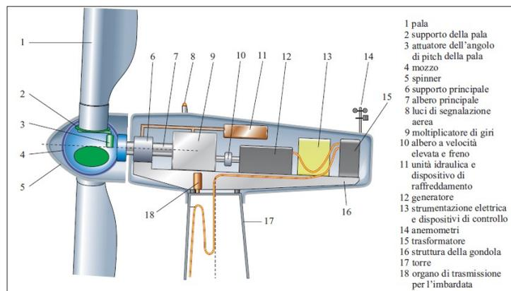
Fig.1 Funzionamento del sistema meccanico dell'aerogeneratore
