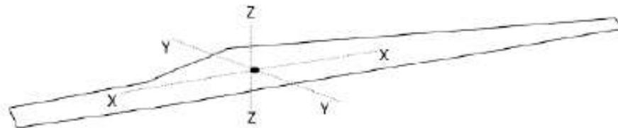
La rotazione della pala intorno all'asse  $zz$  è causato dalla conservazione del momento della quantità di moto: in caso di rottura, per il principio di conservazione, il generico spezzone tende a ruotare intorno all'asse ortogonale al proprio piano. La rotazione intorno agli altri assi è dovuta alle azioni indotte dal vento incidente out of plane sulla pala/sezione di pala. In particolare, si genera:
