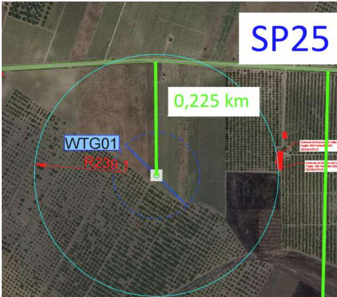
In questo caso, qualora la direzione del vento prevista, coincida perfettamente con l’asse aerogeneratore – viabilità provinciale, si provvederà ad una limitazione del valore di rpm mediante telecontrollo, al fine di rendere sicuro l’esercizio della turbina stessa nei riguardi della gittata della pala eolica.
