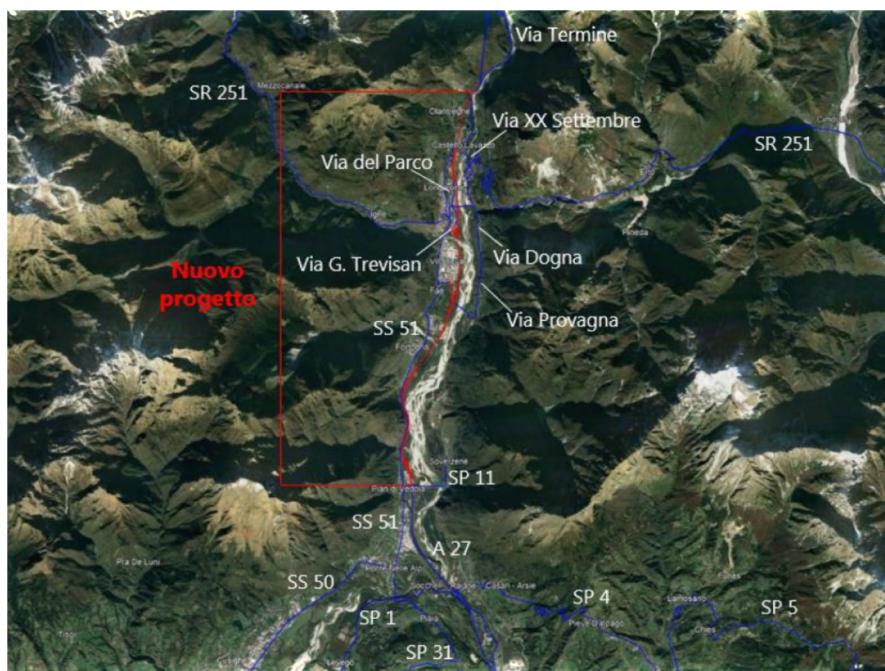
Figura 1 – Configurazione della variante di progetto (in rosso) rispetto alla viabilità esistente
