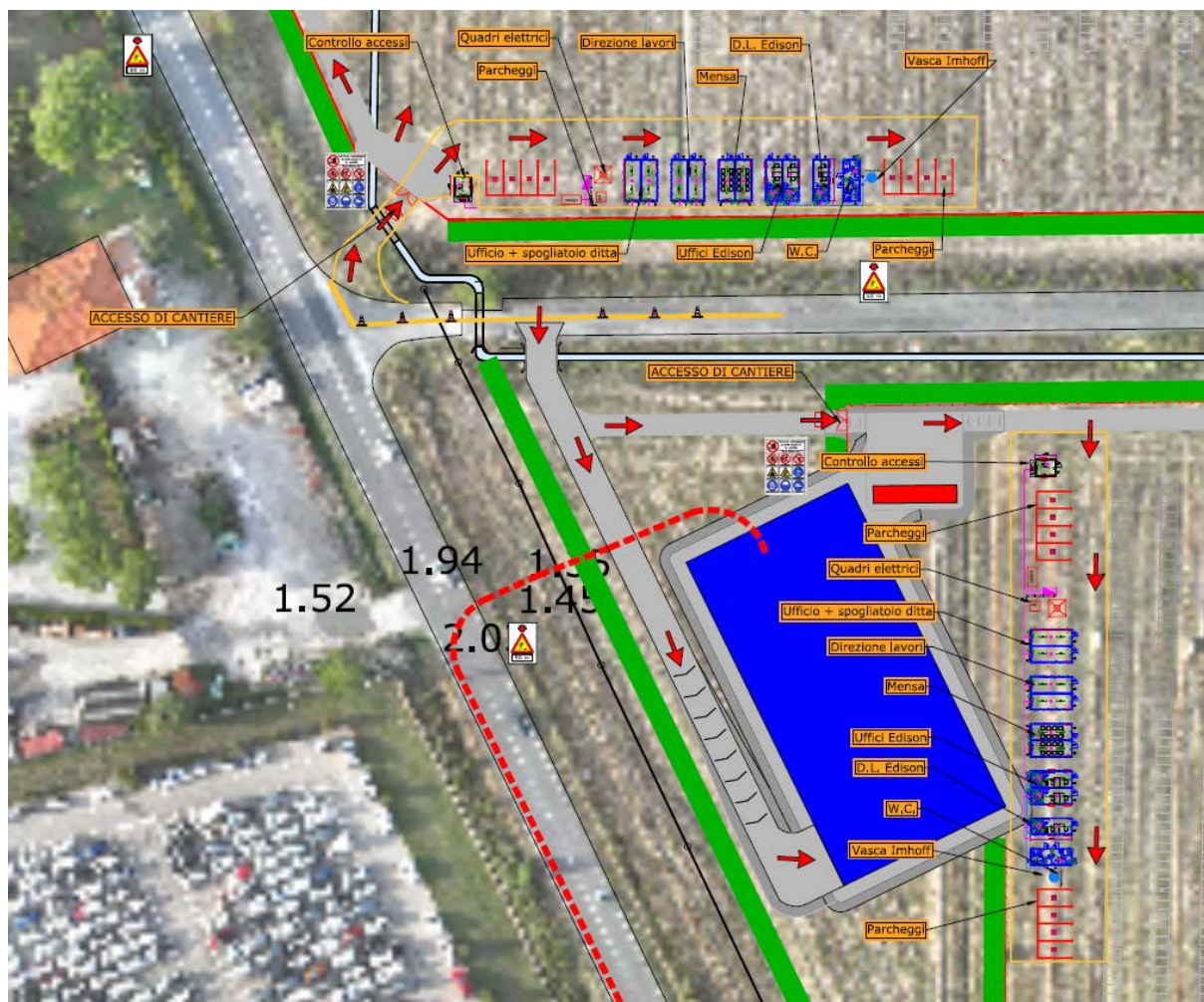
Figura 26 planimetria con indicazione dei baraccamenti di cantiere
