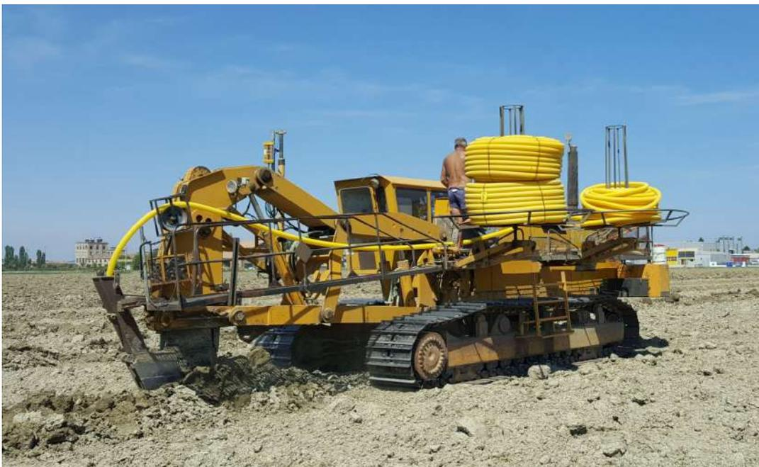
*Figura 6.13 - Posadreni con ripper, anche detta a talpa è il modello della InterDrain 2030GP*
