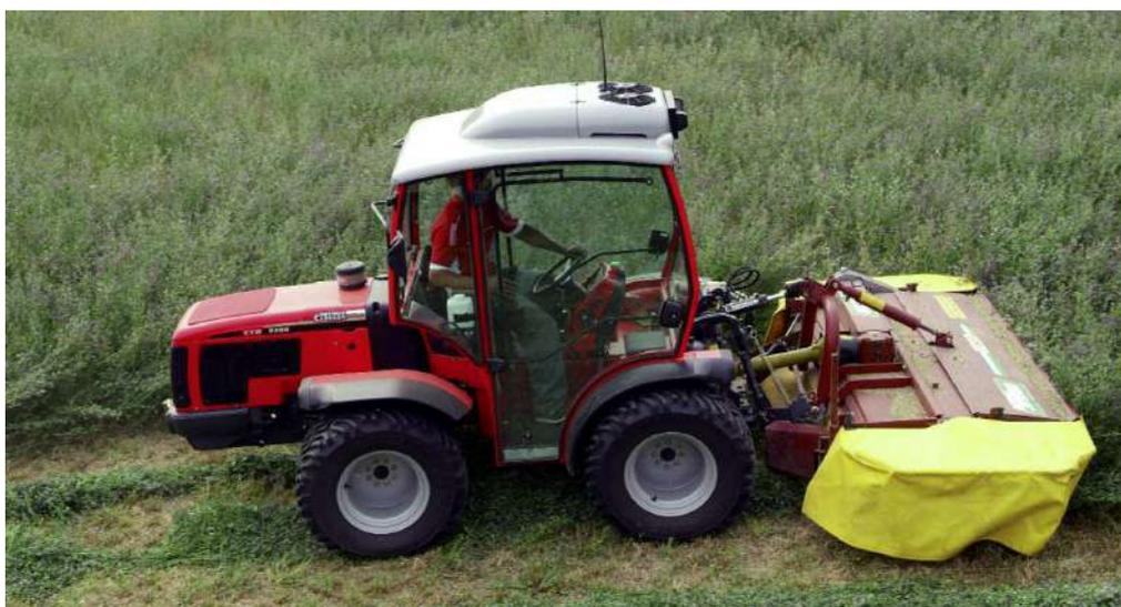
Figura 6.19: Esempio di falciacondizionatrice frontale adatta a piccoli spazi (Foto: Bellon)
