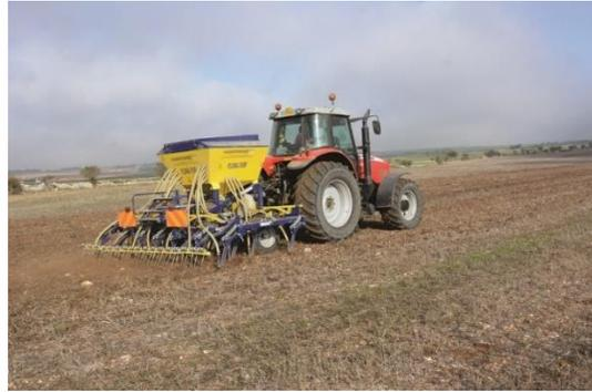
**Figura 5.w.** *Macchine per la semina e per la trasemina: a sinistra seminatrice combinata; a destra seminatrice su sodo*
