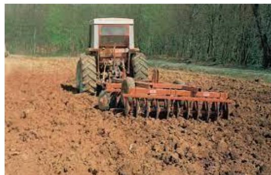
**Figura 5.v.** *Macchine operatrici per la lavorazione dei terreni: a sinistra ripuntatore (o ripper) con rullo frantumatore; a destra erpice frangizolle*
