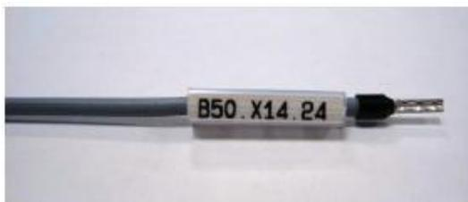
[Fig. 3.7.3.4] – Tipico di una terminazione per il collegamento
