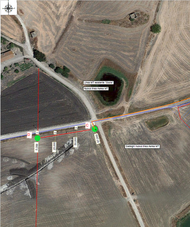
Figura 9 – Tracciato elettrodotto Aereo MT
