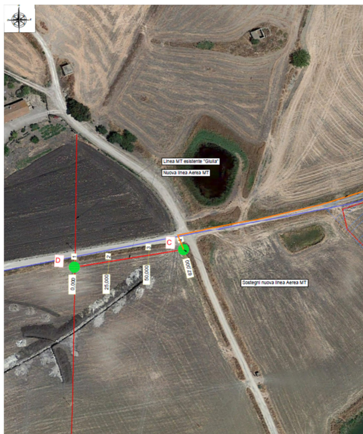
Figura 17 – Tracciato elettrodotto Aereo MT
