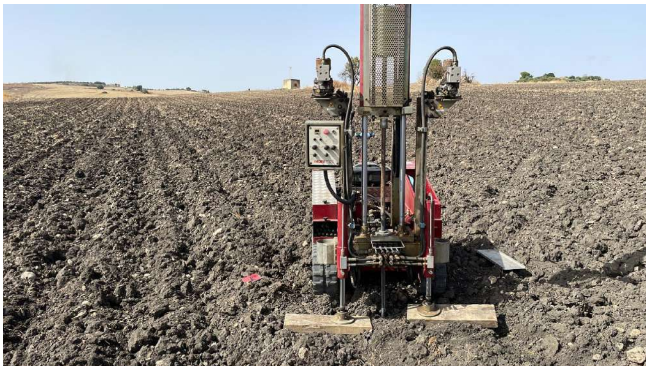
Prova DPHS 7 eseguita in situ
