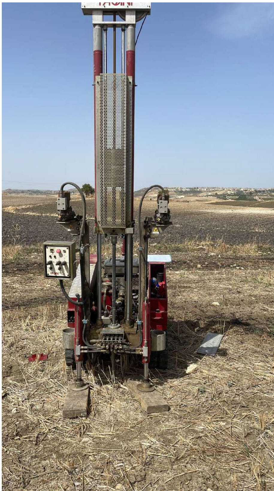
Prova DPHS 2 eseguita in situ
