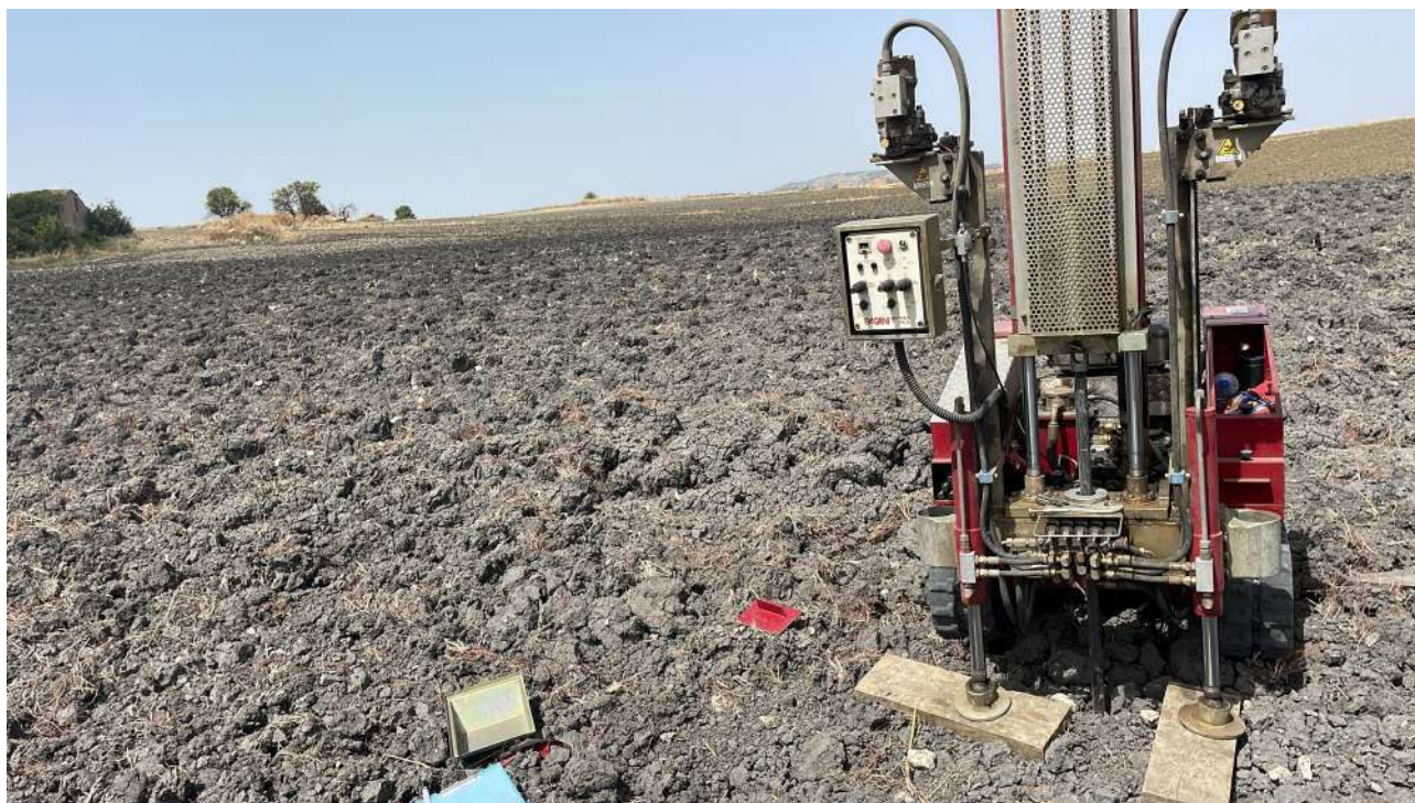
Prova DPHS 5 eseguita in situ
