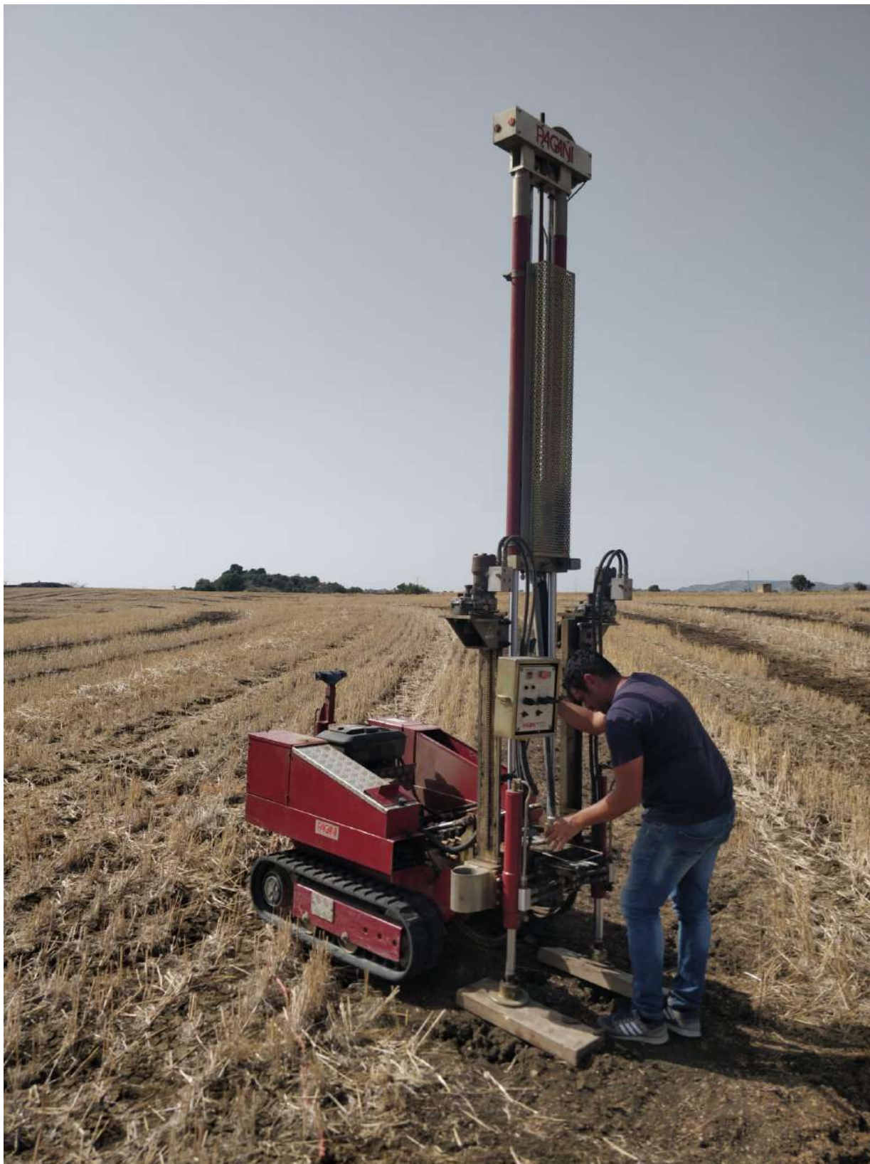
Prova DPSH 1 eseguita in situ
