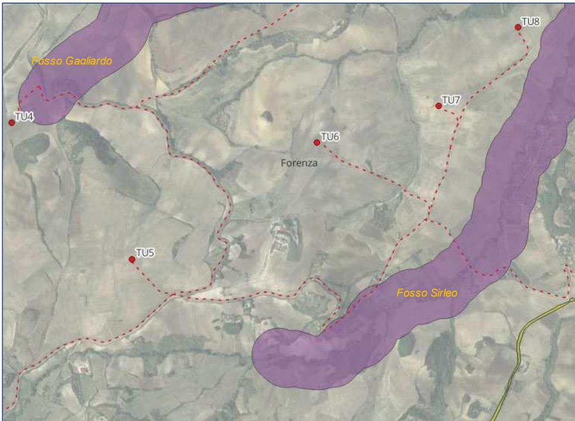
Figura 6- Interferenza del cavidotto con le aree tutelate per legge "fosso Gaigliardo" Fosso Sirleo"
