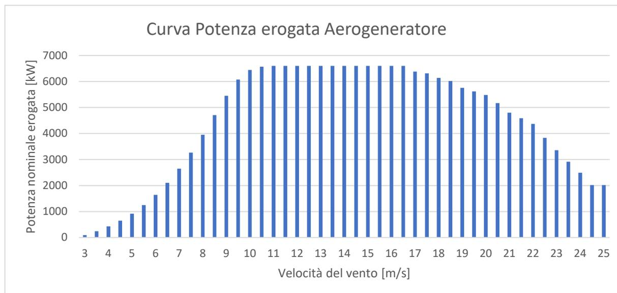
I valori della potenza in uscita e del coefficiente di spinta garantiti dal costruttore in funzione della velocità media del vento all'altezza del mozzo e per una densità dell'aria pari a 1,225 Kg/m<sup>3</sup> sono i seguenti:
