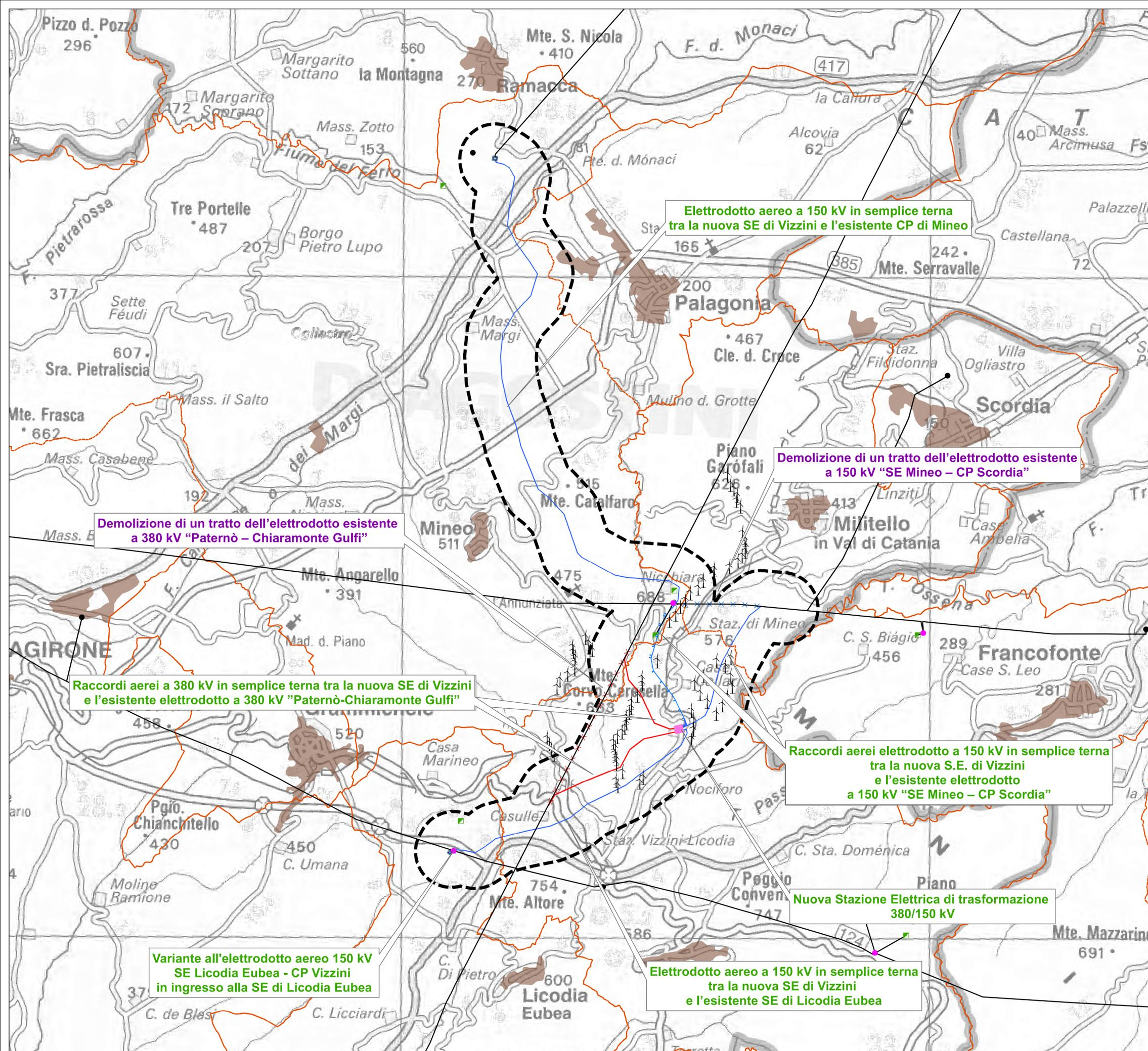
Elettrodotto aereo a 150 kV in semplice terna tra la nuova SE di Vizzini e l'esistente CP di Mineo
