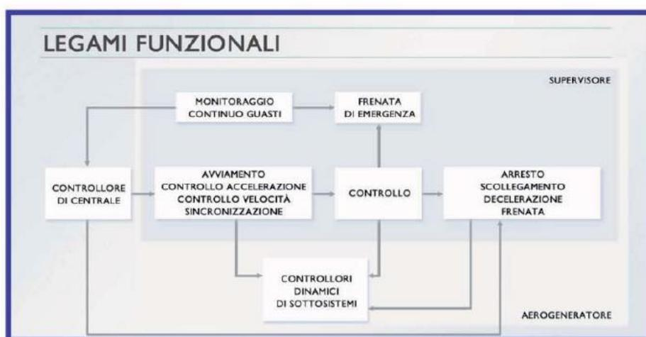
In ogni istante, se tutti i parametri di controllo sono nei limiti predefiniti di funzionamento, l'aerogeneratore può avviarsi automaticamente, ad esempio quando le condizioni di vento consentono di produrre energia,
