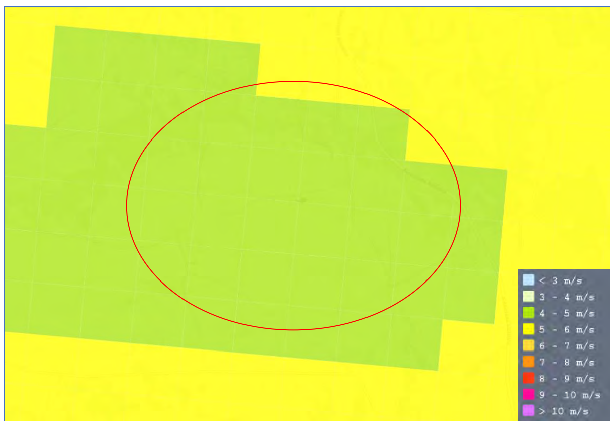
Figura 5 velocità del vento a 50 m s.l.t.
