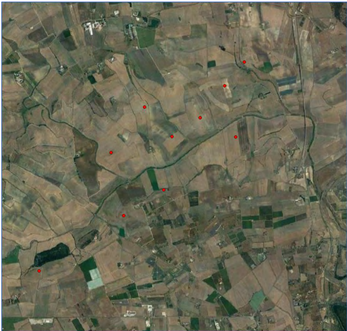
Figura 51 - Ipotesi Layout a 10 aerogeneratori
