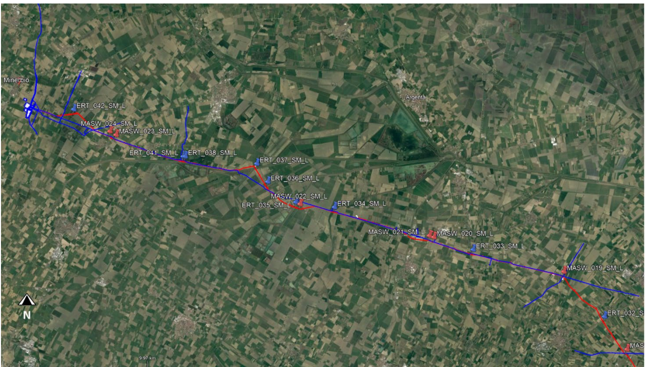
Figura 4-14: Ubicazione indagini geofisiche Tratto 95-140km (in rosso tracciato di progetto, le icone blu, gialle rosse e azzurre indicano rispettivamente le prove ERT, DH, MASW e HVSR.
