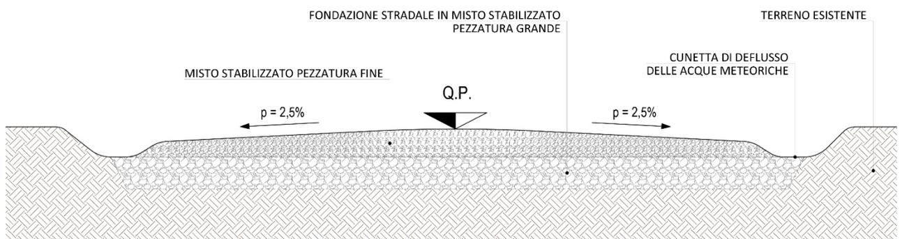
Figura 4 - Sezione tipo viabilità interna
