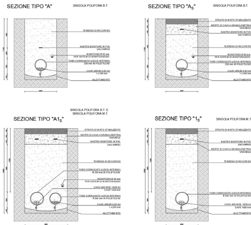
Figura 5 - Sezioni tipo scavi cavidotti
