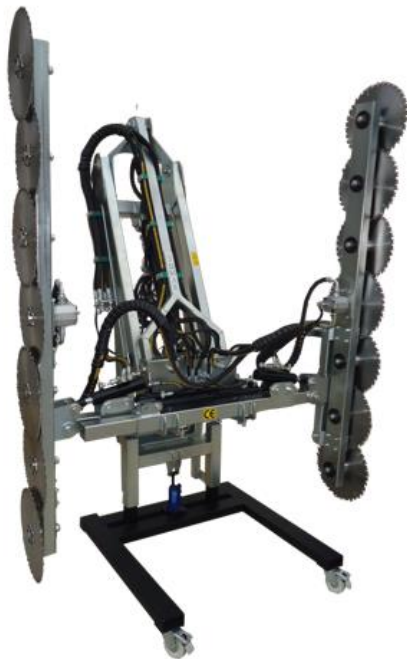
Figura 19- Dischiera per la esecuzione di topping ed headging laterale. Mod. Duplex (sinistra). Particolare di taglio (destra)
