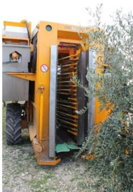
Figura 20- Esempio di macchina vendemmiatrice
