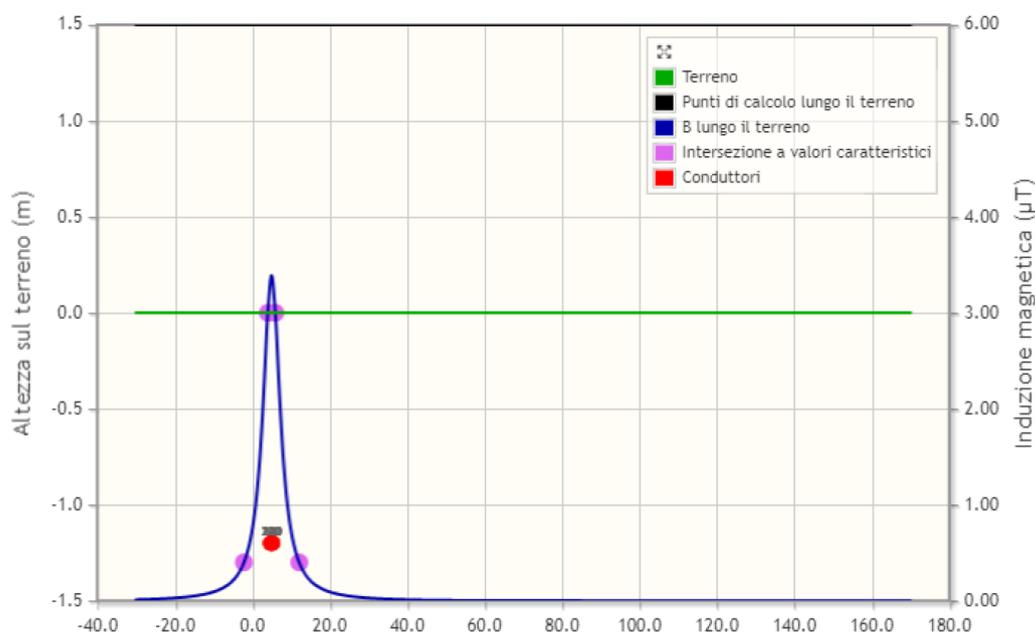
Secondo i calcoli riportati nella Relazione Tecnica, condotti nella condizione peggiore ed in realtà non presente (contemporaneo produzione massima e totale immissione della potenza accumulata per 24 ore), la fascia di rispetto è calcolabile in una distanza dalla linea di 3 metri.
