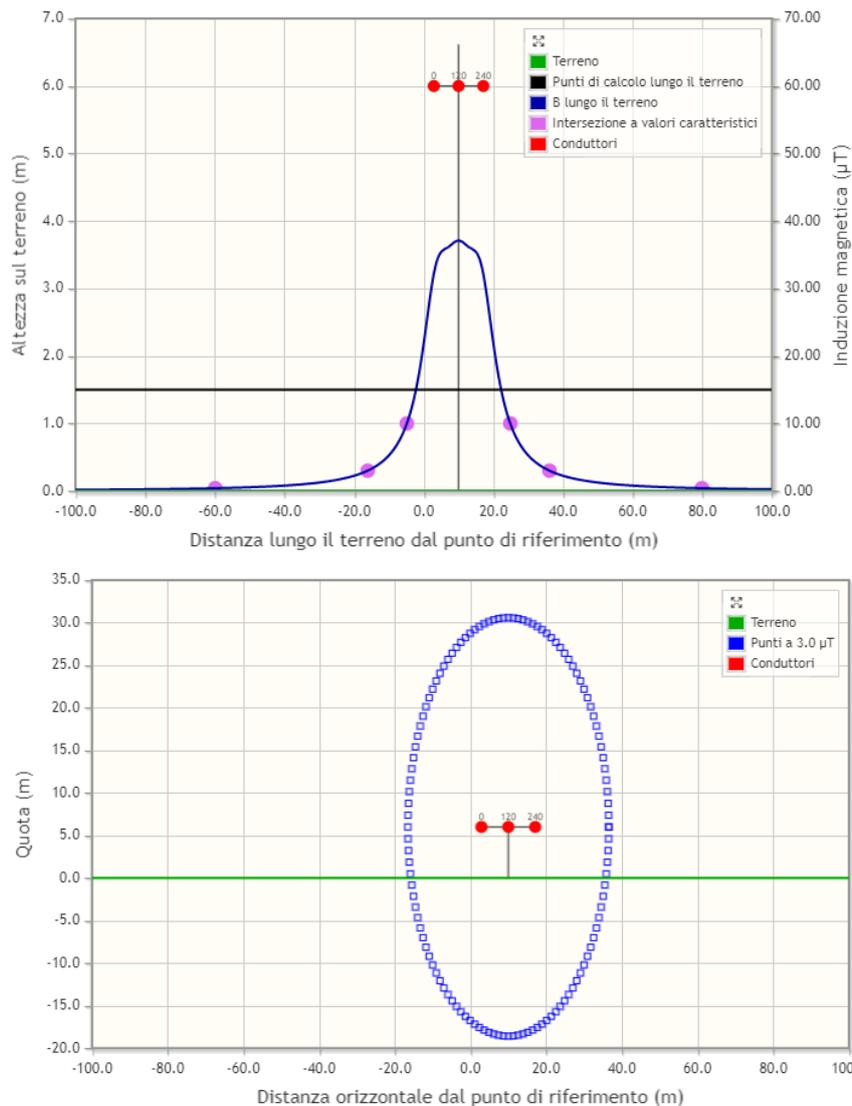
Come si può notare, ad una distanza di 26m dall'asse del sistema di sbarre l'induzione magnetica è inferiore a  $3\mu\text{T}$ . Si può concludere che il campo elettromagnetico complessivo "post operam", determinato
