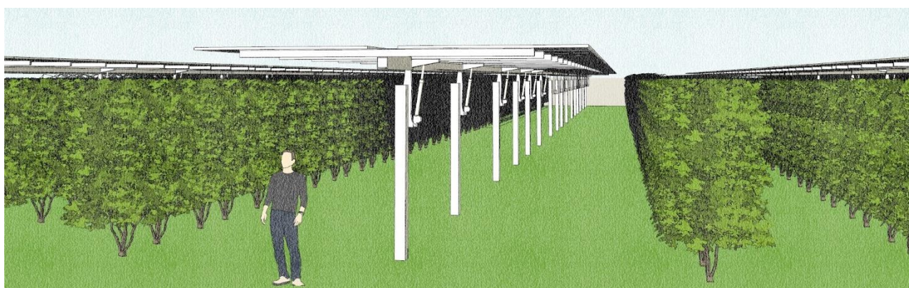
Figura 121 - Esempio con pannelli orizzontali
