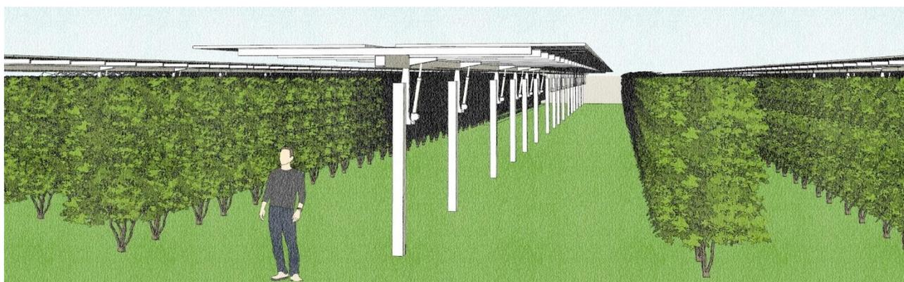
*Figura 123 - Esempio con pannelli orizzontali*
