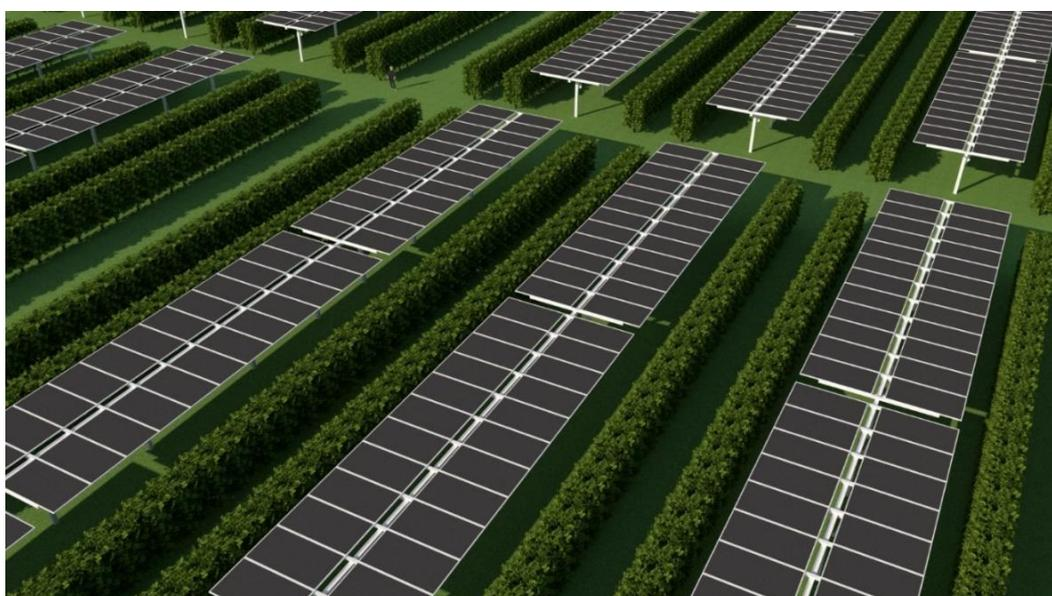
*Figura 22- Schizzo dell'assetto impiantistico: un filare FV e due siepi ulivicole alternate*
