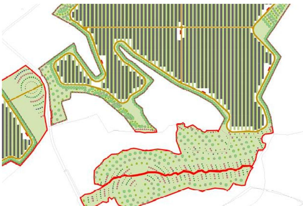
*Figura 133 - Esempio di Piastre e trattamento di bordo per continuità ecologica*
