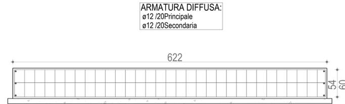
SEZIONE TRASVERSALE DELLA FONDAZIONE - scala 1:25
