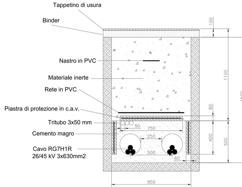
SEZIONE AT IMPIANTO UTENTE PER LA CONNESSIONE
