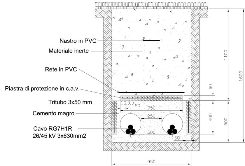
SEZIONE AT IMPIANTO UTENTE PER LA CONNESSIONE
