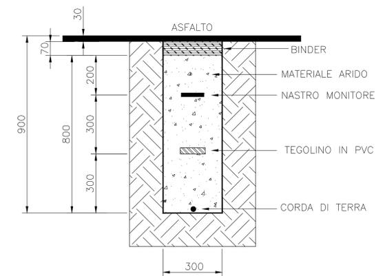
**SEZIONE SU STRADA ASFALTATA TIPO "MA" - TORRE METEOROLOGICA**
