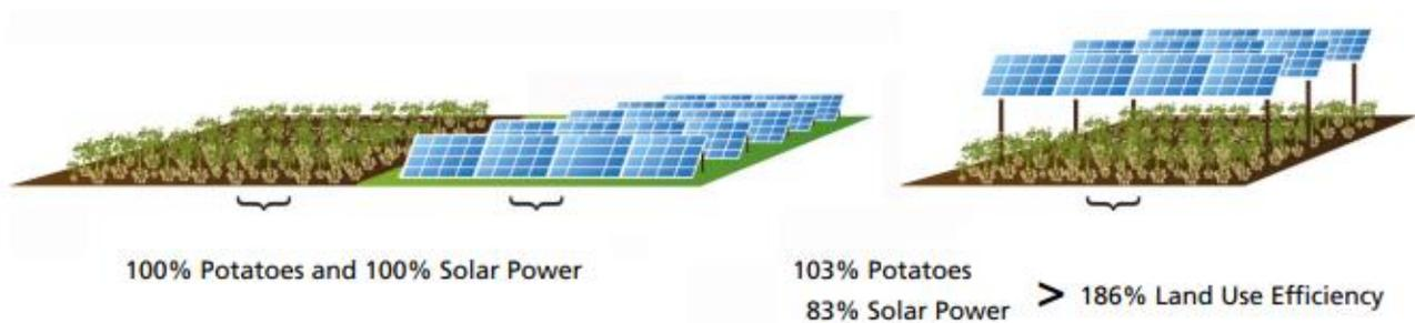
**Figura 16: LER rilevato per l'impianto sperimentale di Heggelbach nel 2017 e nel 2018 (Fonte: Trommsdorff M. et al., 2020)**
