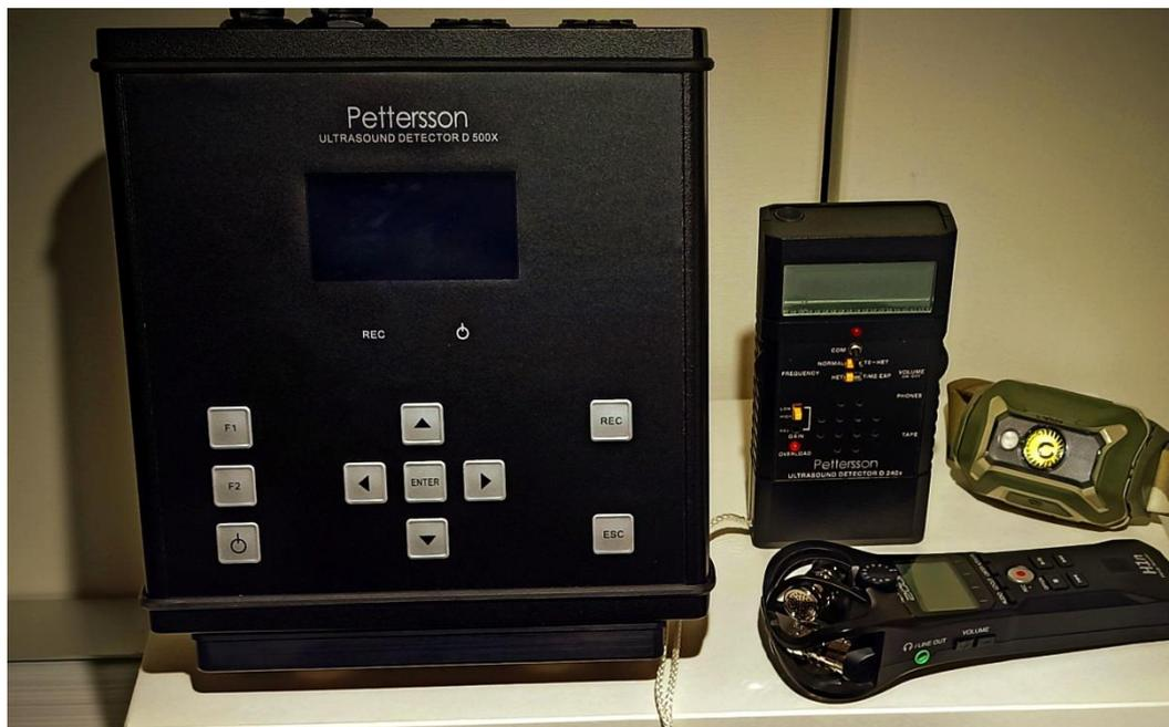
Figura 5 - Attrezzatura utilizzata per il monitoraggio dei chiroteri. Da destra verso sinistra: Bat detector D 500X per la registrazione prolungata in campo degli ultrasuoni. Rilevatore a eterodina ed espansione temporale (x10 e x20 selezionabile). Registratore multitraccia collegato al D 240X.
