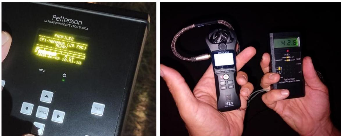
Figura 6- Preparazione del Bat Detector Petterson D500 x per i rilievi su postazione fissa prolungata e D240 per i punti ascolto.
