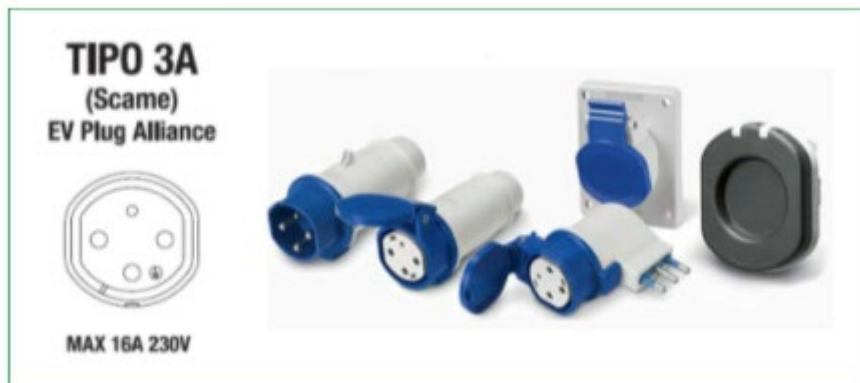
Figura 6– Monofase, 1 contatto pilota, max 16A, 230V, è utilizzato solo per i veicoli leggeri
