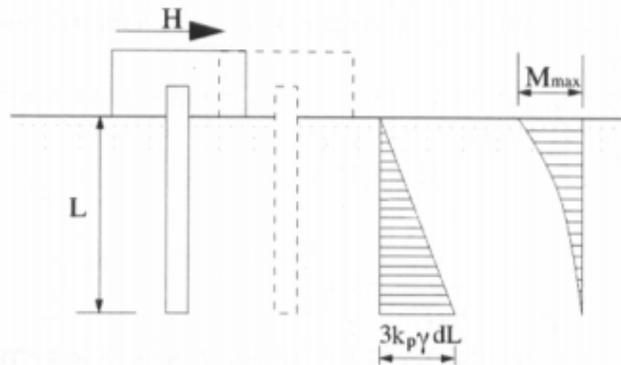
**Figura 16 - Resistenza limite del terreno di un palo impedito di ruotare in testa**
