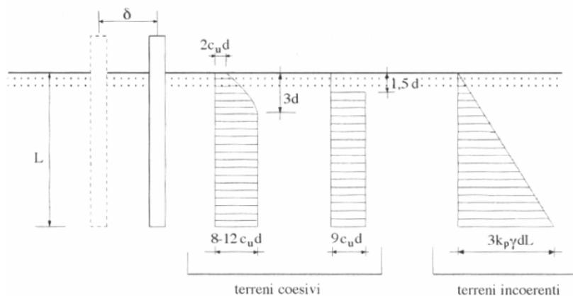
**Figura 15 - Resistenza limite del terreno**
