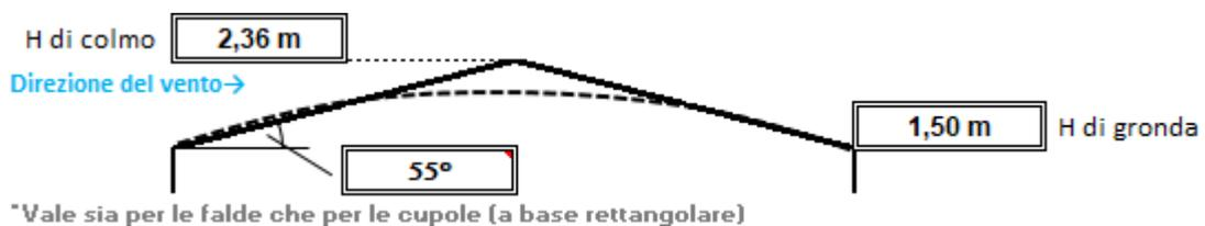
Figura 7 - Schema copertura inclinata per il calcolo dell'azione del vento
