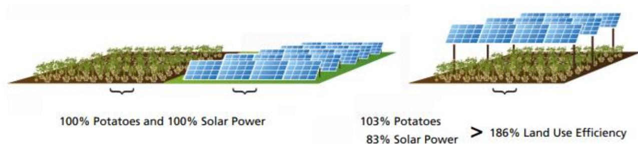
**Figura 10: LER rilevato per l'impianto sperimentale di Heggelbach nel 2017 e nel 2018 (Fonte: Trommsdorff M. et al., 2020)**
