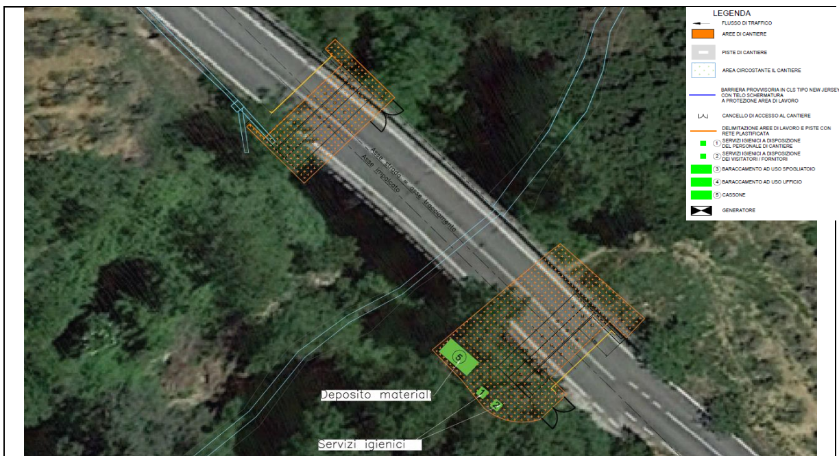
Figura 13 - Cantiere Fase 1 - Esecuzione nuove fondazioni al di sotto del ponte esistente
