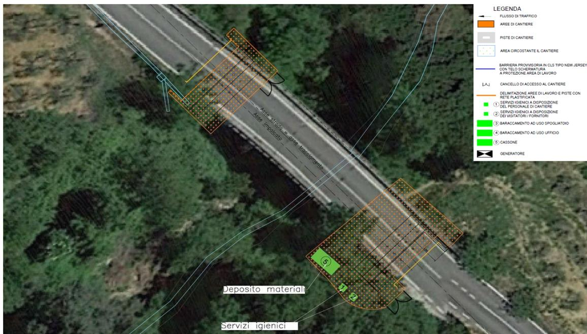
Figura 14: Cantiere Fase 1 - Esecuzione nuove fondazioni al di sotto del ponte esistente
